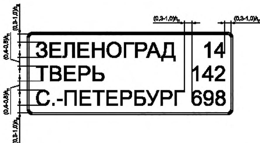
Рисунок Г.5 — Пример компоновки знака индивидуального проектирования 6.12
