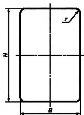
Рисунок Д.7 — Размеры прямоугольных знаков вертикального формата
