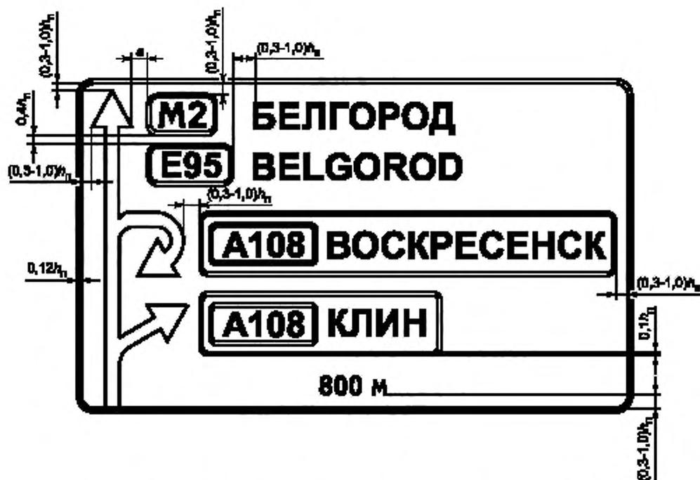
Рисунок Г.3 — Пример компоновки знака индивидуального проектирования 6.9.1
