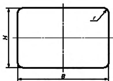
Рисунок Д.8 — Размеры прямоугольных знаков горизонтального формата
