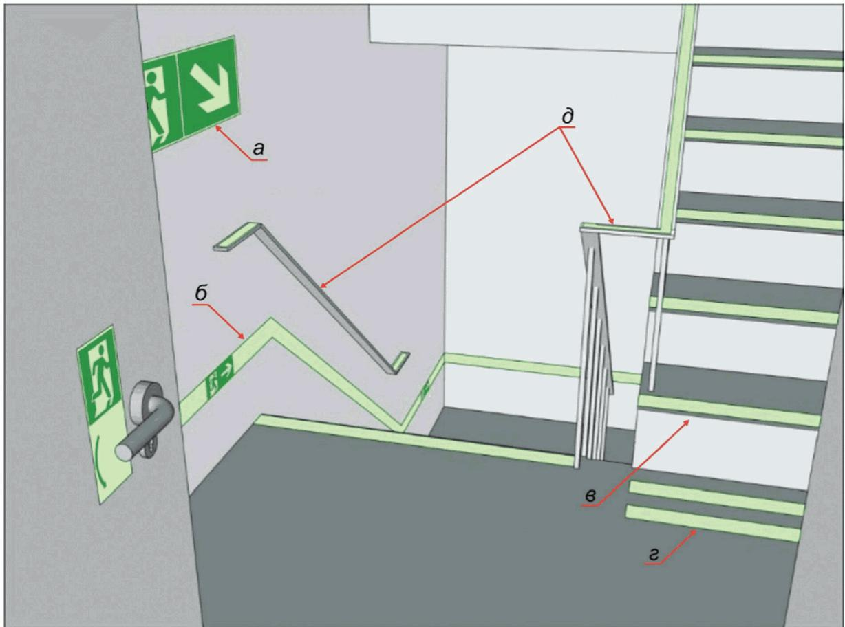
а - комбинированный указатель направления эвакуации; б - обозначение геометрии лестничного марша и площадки при помощи низкорасположенной настенной направляющей линии с включенным в ее состав указателем направления эвакуации; в - обозначение переднего горизонтального края ступеней фотолюминесцентными полосами; г - обозначение окончания лестничного марша двумя параллельными фотолюминесцентными полосами; д - обозначение перил лестницы фотолюминесцентной полосой
