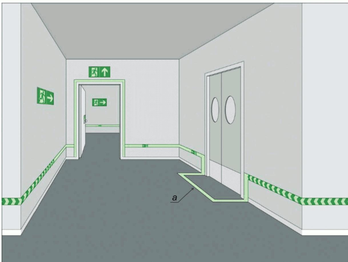
а - обозначение геометрии безопасного эвакуационного пути напольной фотолуминесцентной полосой
