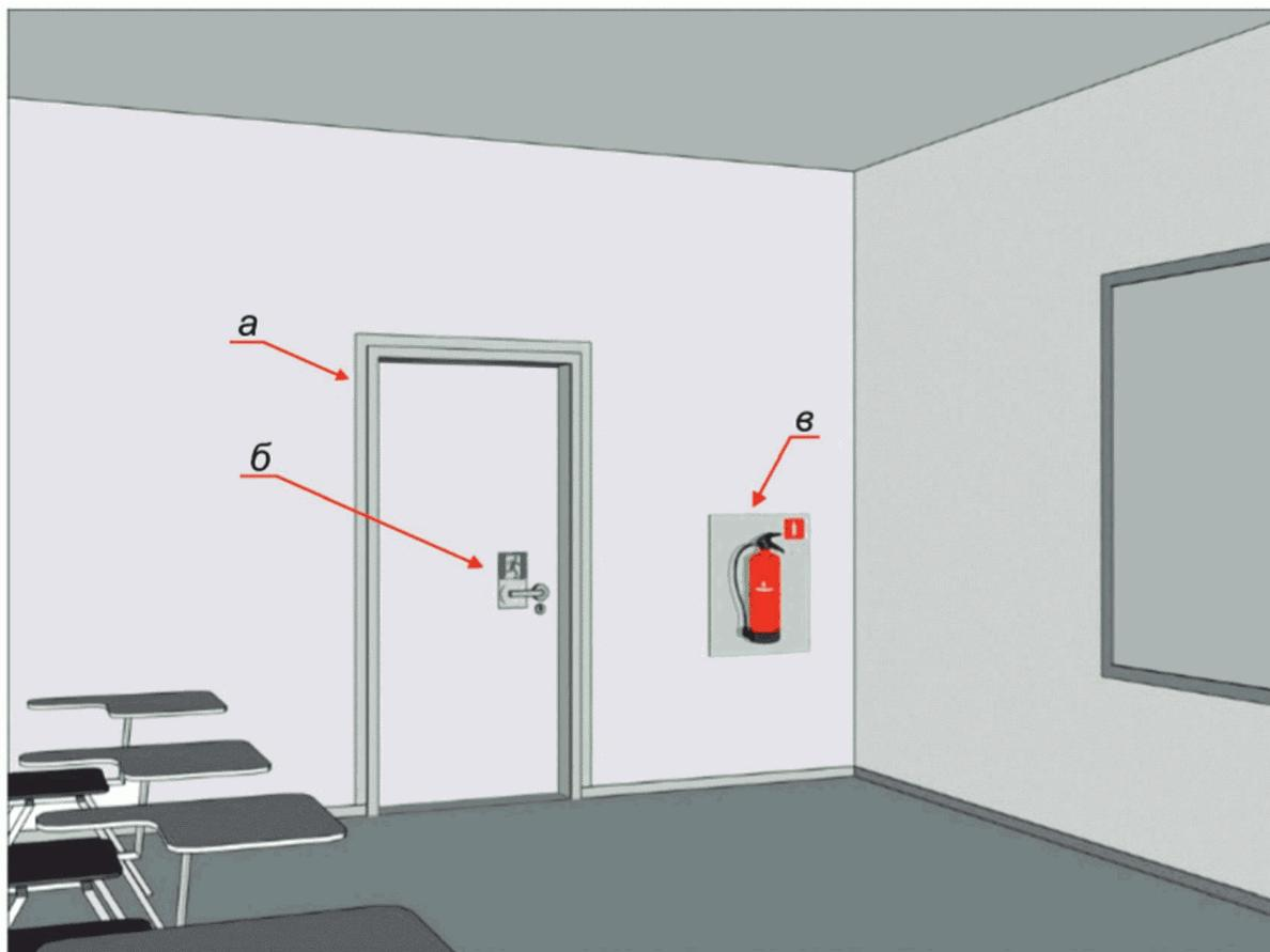
а - обозначение контура двери фотолуминесцентной полосой; б - обозначение механизма двери; в - пример обозначения места размещения огнетушителя при помощи светового экрана
