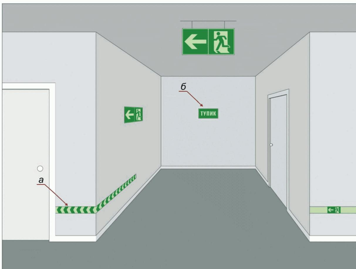
а - низко расположенная направляющая линия со стрелками для дополнительного указания направления эвакуации; б - обозначение тупика
