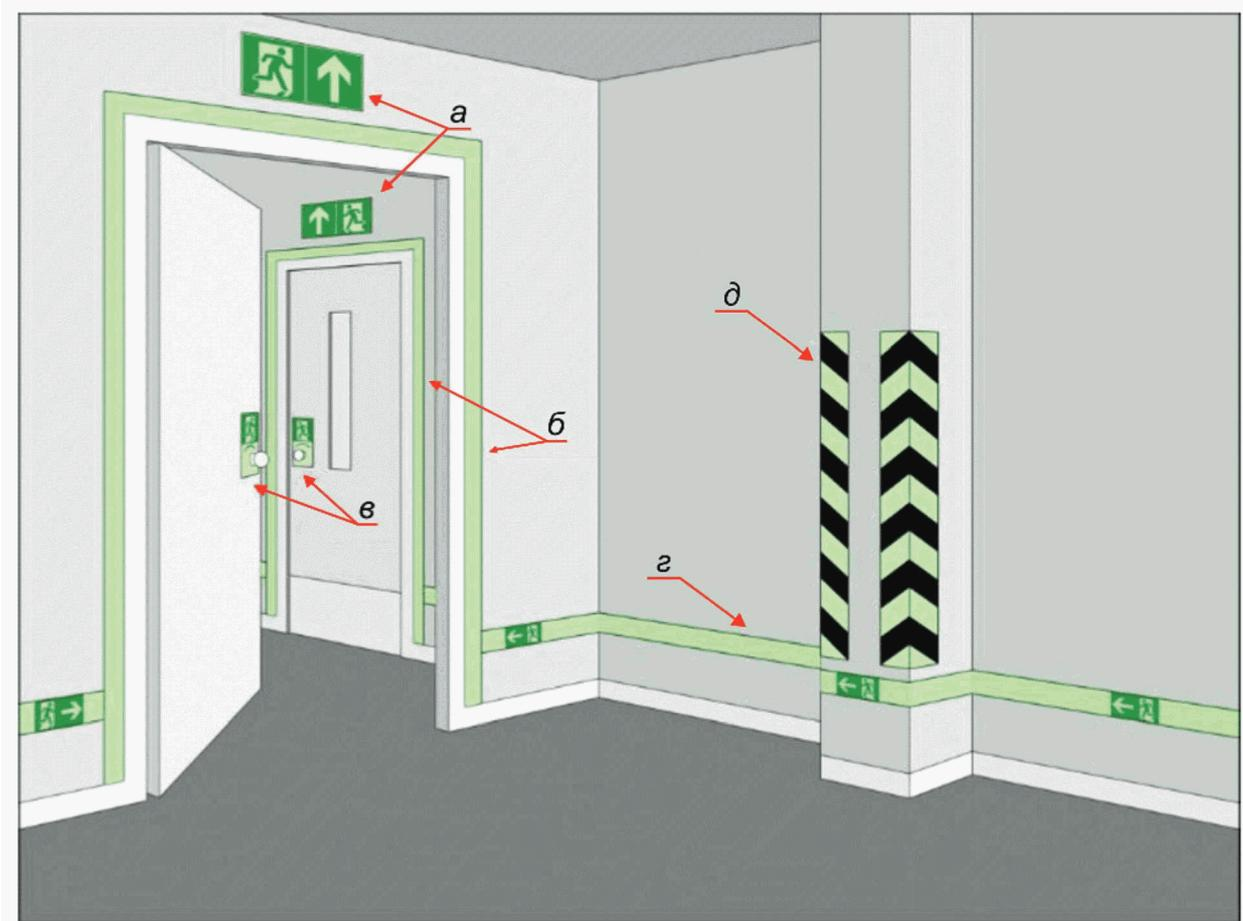
а - указатель направления эвакуации, размещенный над выходом; б - обозначение контура двери фотолуминесцентной полосой шириной 50 мм; в - обозначение механизма двери; г - низко расположенная настенная направляющая линия с включенным в ее состав указателем направления эвакуации; д - обозначение опасной зоны или конструкции здания, которая может стать причиной травмы
