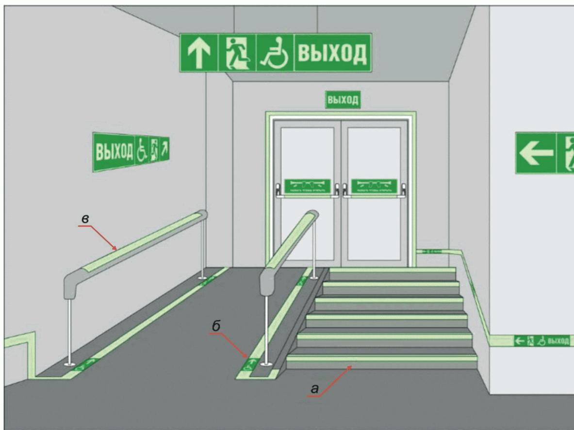
а - обозначение переднего горизонтального и вертикального краев ступеней фотолюминесцентными полосами; б - обозначение краев пандуса фотолюминесцентной напольной направляющей линией с включенным в ее состав указателем направления эвакуации; в - обозначение перил пандуса фотолюминесцентной полосой
