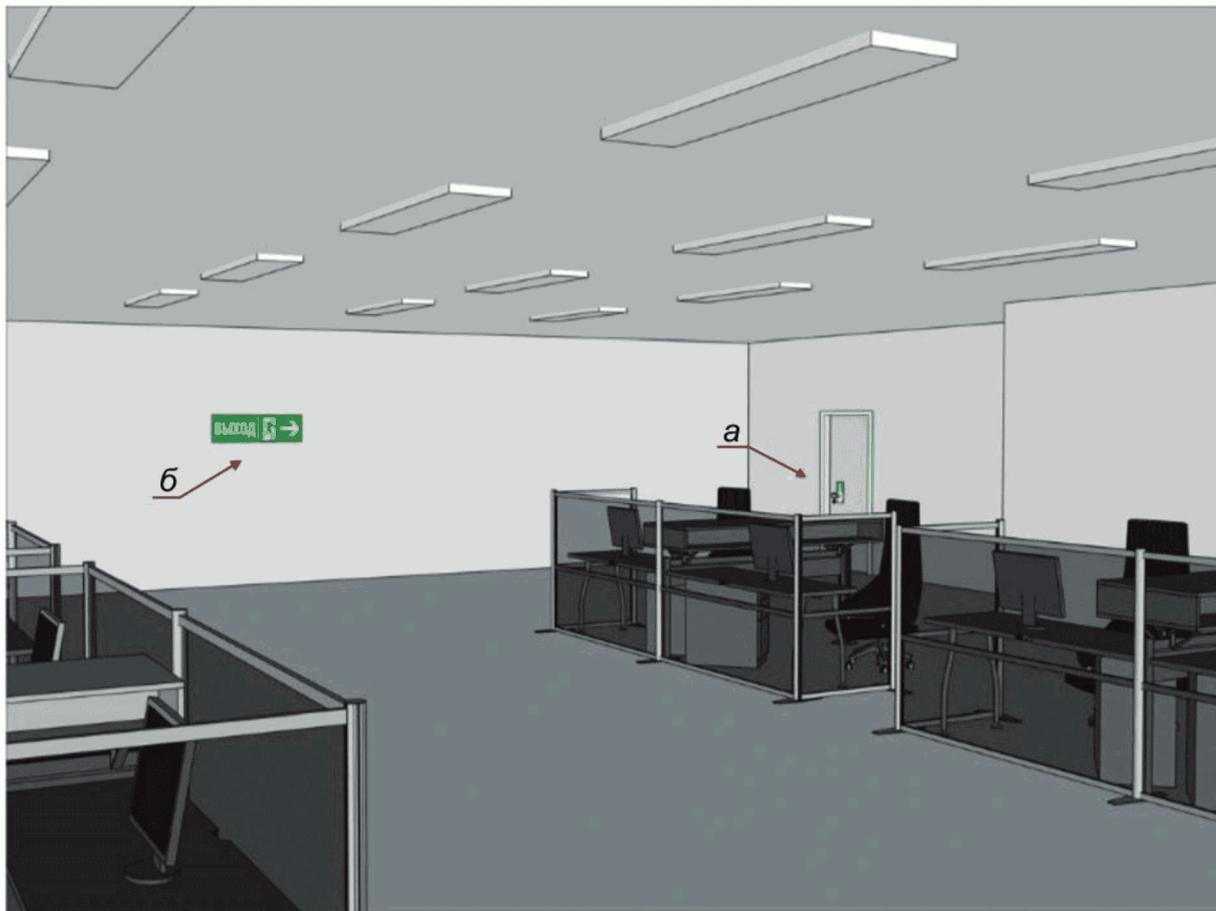
а - обозначение контура и механизма двери; б - указатель направления эвакуации
