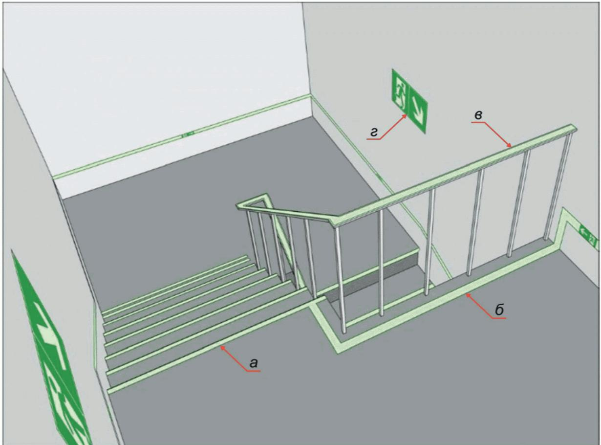
а - обозначение переднего горизонтального края ступеней фотолюминесцентными полосами;
