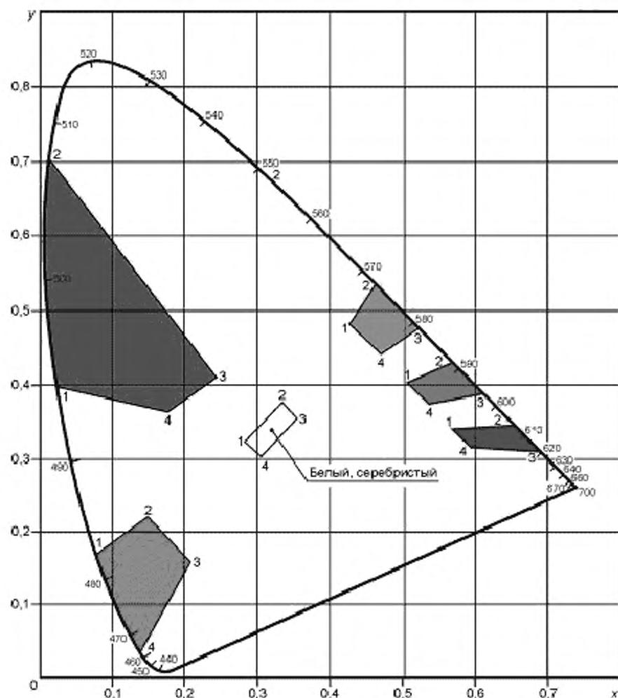
Рисунок 1 — График цветовых областей для знаков со световозвращающей поверхностью
