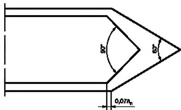
Рисунок Г.2 — Конфигурация оголовка знака индивидуального проектирования 6.10.2
