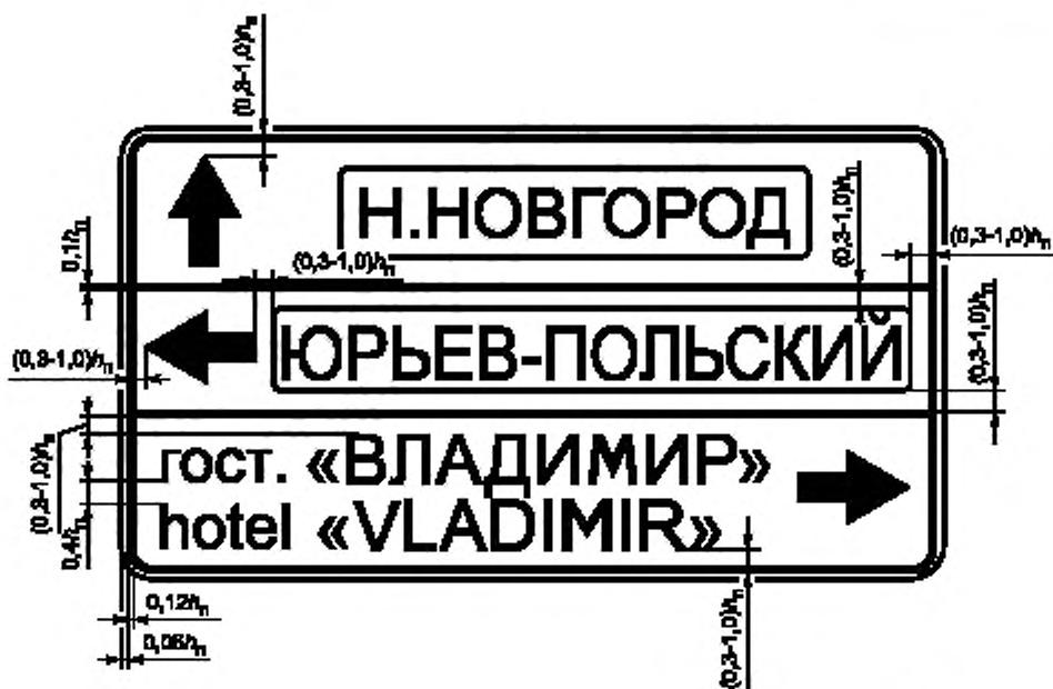
Рисунок Г.4 — Пример компоновки знака индивидуального проектирования 6.10.1
